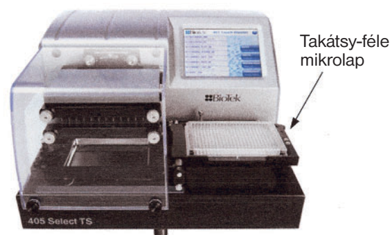
3. ábra. A Takátsy-féle mikrolapok kezelésére (pipettázás, titrálás, tisztítás) épített automata berendezések egyike
