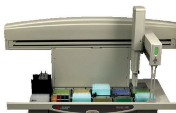
4. ábra. a) Csuklókaros karteziánus multifunkciós laboratóriumi robotkonfiguráció [11]. b) Biomek 3000 gyártmányú robotkar-vezérsín. c) Onyx (ALS Automated Lab Solutions) típusú, mikrolapokat alkalmazó laboratóriumi robotkonfiguráció [34]
