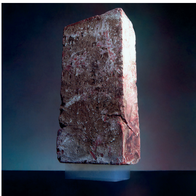
3. ábra. Építési (2,5 kg-os) téglát megtartó 0,2 g-nyi aerogél [7]
